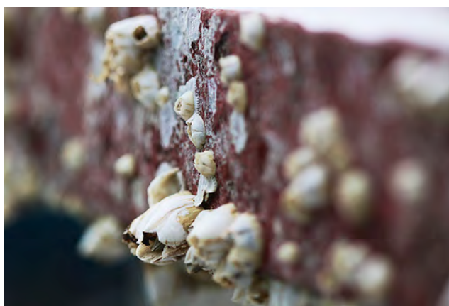
Figur 1. Organismer som växer på ett båtskrov orsakar slitage på bottenmaterialet samt ökar konsumtionen av bränsle. Bilden visar en del av ett skrov som trots behandling av antifoulingprodukter har tillväxt av havstulpaner. Foto av: Chris Frey 2013
