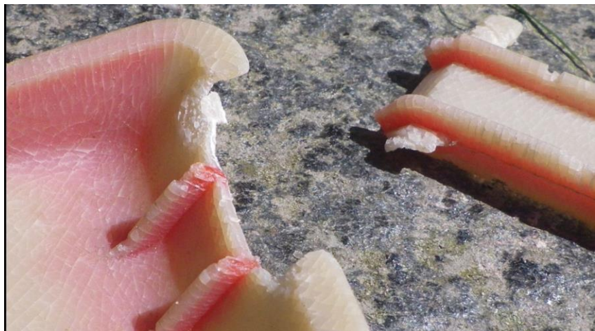
Figur 3: Gammal leksaksspade som har börjat falla isär på grund av förlust av mjukgörare i plasten. (egen bild)
